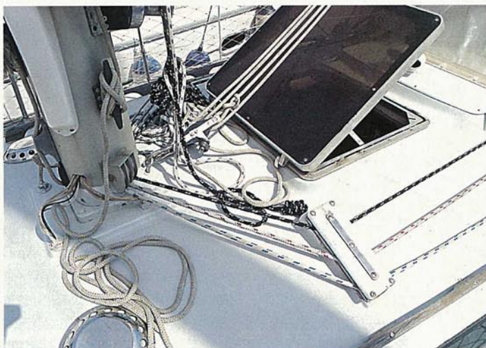
Detalle de la base del palo, con sus salidas de drizas integradas. Algunos armadores han sustituido estas salidas por drizas exteriores con rodamientos.
