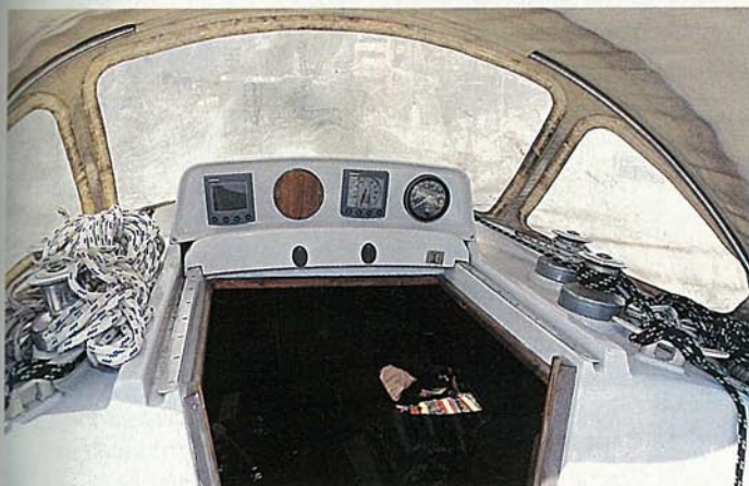
El Puma 34 fue de los primeros modelos en llevar la maniobra del palo a la bañera. Lógicamente los elementos originales del acastillaje (winches simples y cornamusas) han quedado ya obsoletos.
