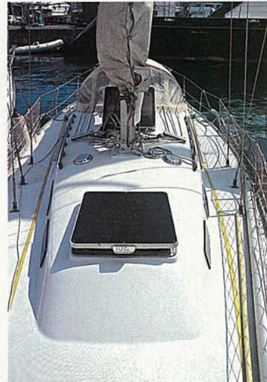
Las formas rectangulares del techo de la cabina liberan un buen espacio horizontal, tanto en proa como en las bandas.
